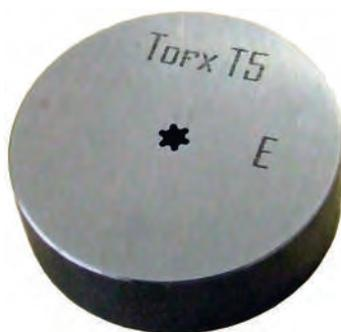
Bague de contrôle de profil typ Torx ® suivant spécifications client.
