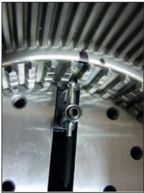
Touche à bille carbure pour contrôle de denture sur table de mesure.
