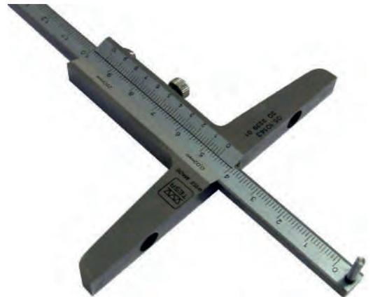
Ajout d'une butée cylindrique pour contrôle de position d'alésage sur jauge de profondeur.
