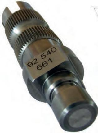
Etalon morphologique pour machine de tri.
