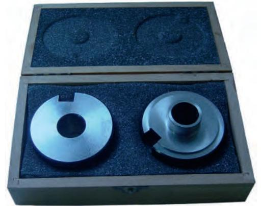
Etalon et master pour poste de contrôle multicote.
