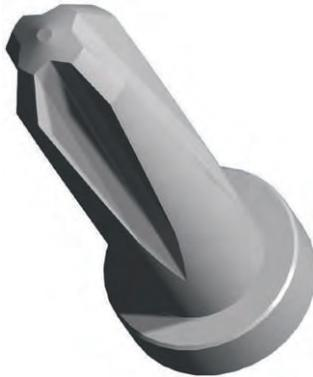
Prüfschablone für Kreuzschlitz
