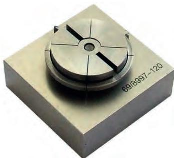
Aufsatz mit Dehnzange zur Prüfung von Uhrenteilen.
