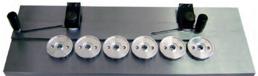
Positionierungsaufsatz und Schnellaufspannung für Serien 3D-Kontrolle.
