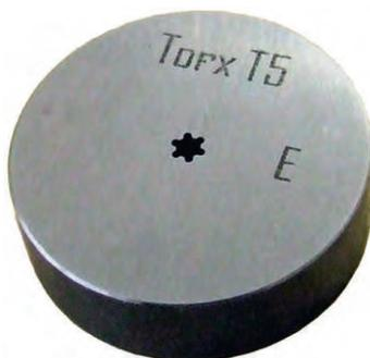
Profil-Prüfing Typ Torx® nach Kundenspezifikationen .
