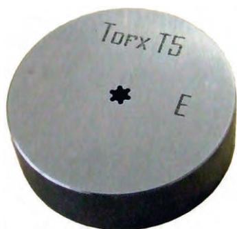
Profil-Prüfing Typ Torx ® nach Kundenspezifikationen .
